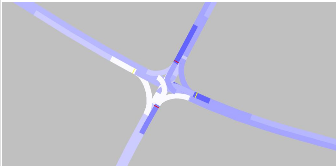
Рисунок 9.2 Плотность транспортного потока. Ситуация со светофорным регулированием
