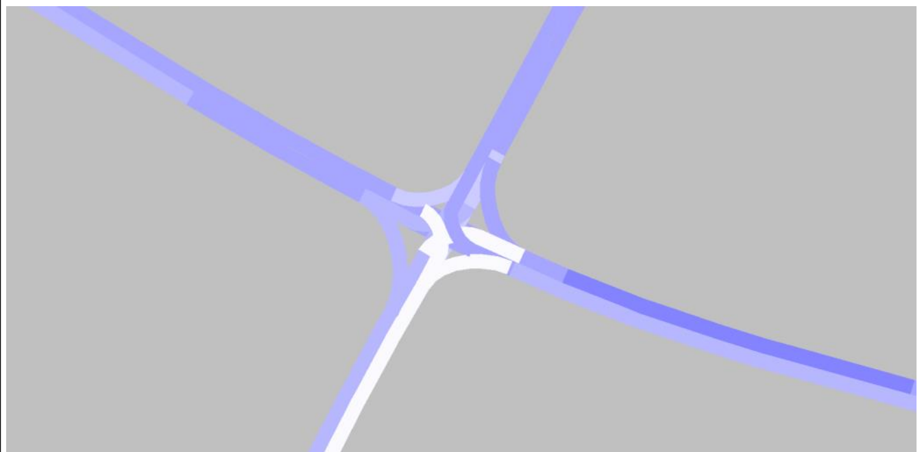
Рисунок 9.1 Плотность транспортного потока. Ситуация без светофорного регулирования.
